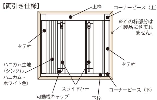
※枠材：上枠、下枠、タテ枠、受枠、スライドバー
