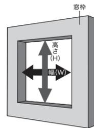
窓枠の幅、高さの内側寸法を測ってください。
